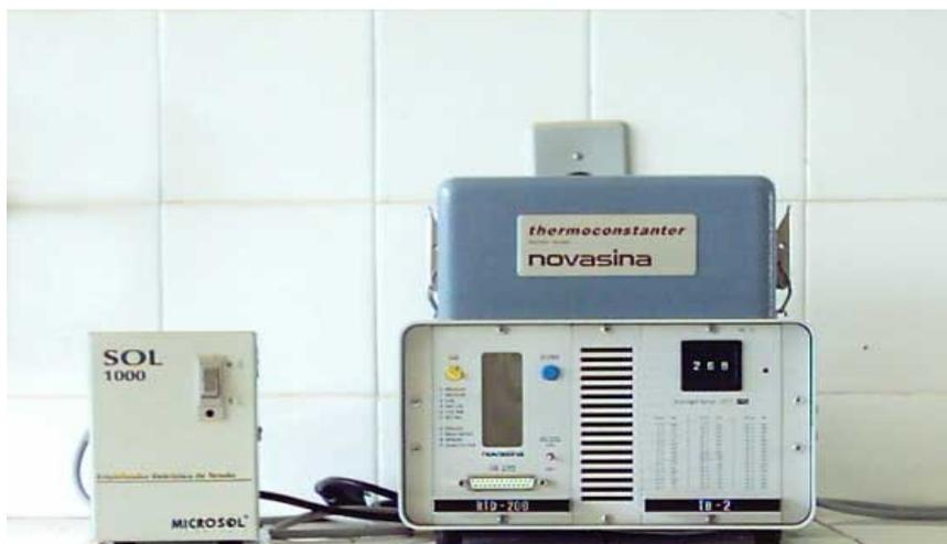
Figura 2 – Equipamento Thermoconstanter Novasina TH-02, utilizado para determinação da atividade de água.
